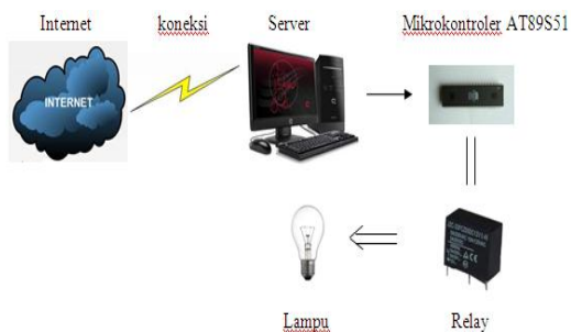
Gambar 5. Blok diagram Sistem kontrol lampu otomatis berbasis Web
